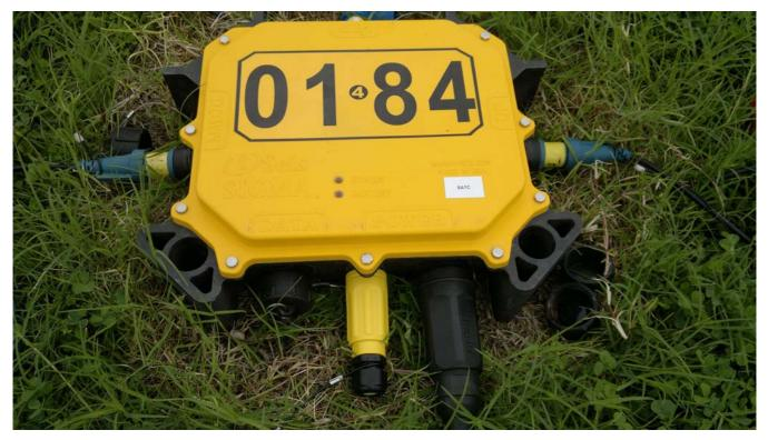
只要我们能充分考虑常规有线系统与无线系统之间存在的内在差异,以及不同仪器所需采取的不同操作方式,就可以得到这些问题的最佳答案。有线设备中电缆的使用基于下属三个原因。第一,向远程采集站发送计时信息;第二,发送远控指令;第三,通过电缆传回质量控制(QC)、采集状态信息及大量地震数据。无线系统的制造商都要考虑是否要结合一些无线方法来模拟这些功能,或直接提出舍弃这些常规做法的原因。
