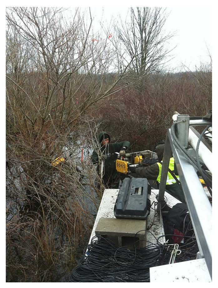
当前,无线采集技术在被物探行业认可的同时尚存在几点疑问,例如其是否能彻底摆脱有线采集系统的缺陷。其中大家一致认为的一个主要问题便是关于设备的重量。当采集项目遇到一些不正常的道间距和检波器类型的组合时,相比无线采集系统,有线设备地震队的装备重量总是变的更重。(如对此有质疑,可查阅在 2010 年 6 月出版的"地震波初至"杂志中发表的一篇题目为:"权衡无线和有线采集系统未来在陆上地震采集中扮演的角色"的文章,并可自行进行数学计算)。但是在采集项
