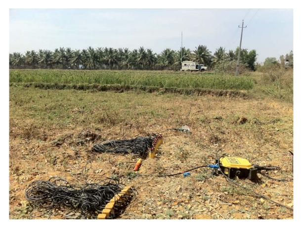
但是如果你选用的硬件不能提供实时数据回传,或是不以实时的方式进行操作,那么人们为了得到 采集的数据,迟早必将需要到野外从采集箱体中重新回收数据。此资料回收方式大致有两种选择 ——一种是要求必须将装置收集到一个中心位置,在此连接到某一机架上来获取数据;另一种则是, 你可以到达部署装置的地方,在采集箱仍然记录数据的同时抄写数据。后一种方法具备几个明显优 势,即速度快,所需设备少。如果你不需要拾取采集箱,只是人工抄写数据,那么设备可以这样一 直不停地工作。
