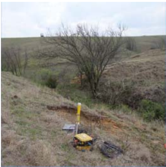
配有 Sigma 盒子的地震测线及 HyMesh 通信网
